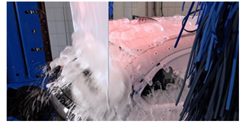
Vaahto virtaa FlexStream-kattokuivurista vaahtoverhoksi, joka kattaa ajoneuvon kokonaan.
